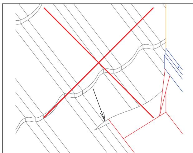
**Обход трубы, расположенной на скате, ширина трубы не превышает 80 см, расстояние от конька до задней грани трубы не превышает 1 м**
