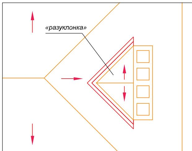
Кровельщик с хорошими навыками жестянщика найдет способ надежно провести воду даже мимо трубы, стоящей в ендове. Начинающим кровельщикам лучше не экспериментировать и пригласить на этот участок работы опытного жестянщика, например специалиста по фальцевым кровлям, или добиться переноса трубы из ендовой.
