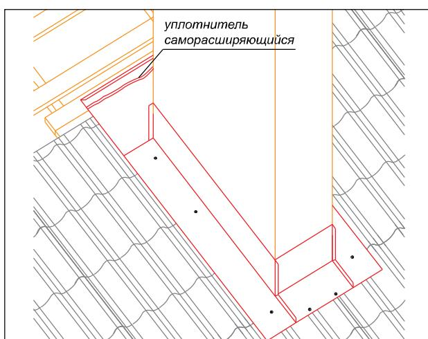
Соедините 3 детали фартука между собой и закрепите саморезами нижний фартук на металличерепице.
