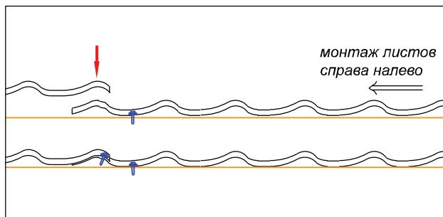
Причина такого утолщения понятна из рисунка. Для устранения такого утолщения нужно на одном из нижних листов слегка «выпрямить» капиллярную канавку ниже линии штамповки или срезать небольшой фрагмент угла, что незначительно усложняет монтаж.
