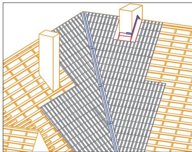
и течет по линии сгиба ендовы. Прошлогодние листья, попавшие на кровлю, также попадают под накладку ендовы и при достаточном зазоре между резанными краями металличерепицы будут смывты водой вдоль планок ендовы.
