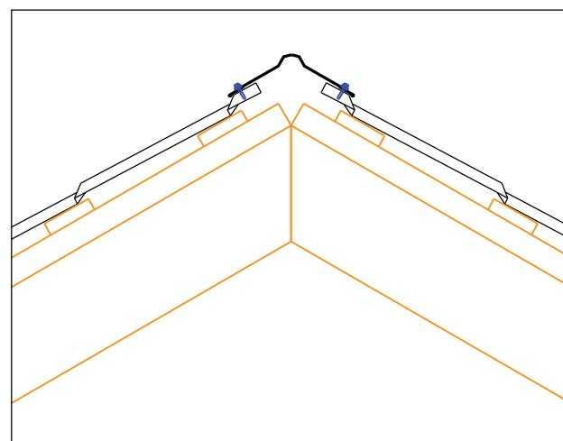
Поскольку эти точки расположены на одинаковом расстоянии от обрешетки, торцевая планка не будет деформироваться при затягивании саморезов до штатного сжатия прокладки.
