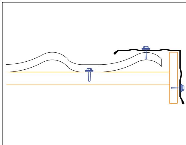
Если ширину ската не «подгоняли» под размер волны металличерепицы, лист может подойти к одному из фронтонов нижней частью волны. При этом штатная фронтонная планка не накроет гребень. Откорректируйте, если это возможно, величину фронтонного свеса или смонтируйте дополнительную страховочную кровельную планку, изготовленную специально для этого места. Смонтируйте, при необходимости, универсальный уплотнитель между страховочной кровельной планкой и листом металличерепицы.
